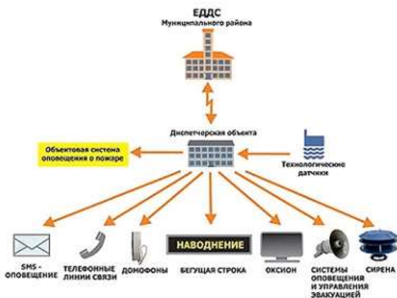
Рис. 3. Структурная схема системы оповещения
