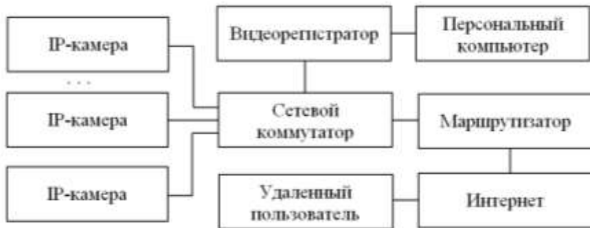
Рис. 2. Структурная схема цифровой системы видеонаблюдения с удаленным режимом просмотра
