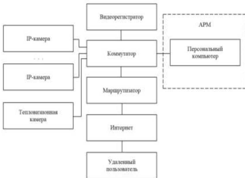
Рис. 3. Структурная схема системы видеонаблюдения
