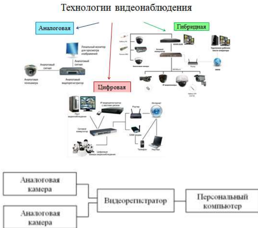
Рис. 1. Структурная схема аналоговой системы видеонаблюдения
