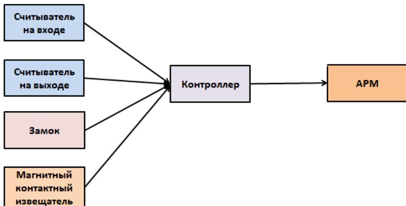
*Рис. 2. Структурная схема системы контроля и управления доступом для одного рабочего помещения*
