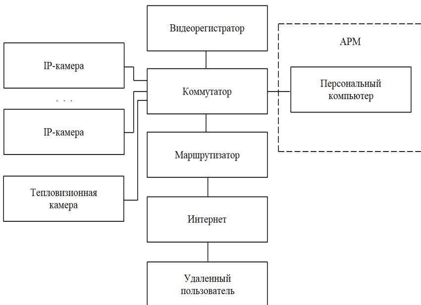
Рис. 3. Структурная схема системы видеонаблюдения
