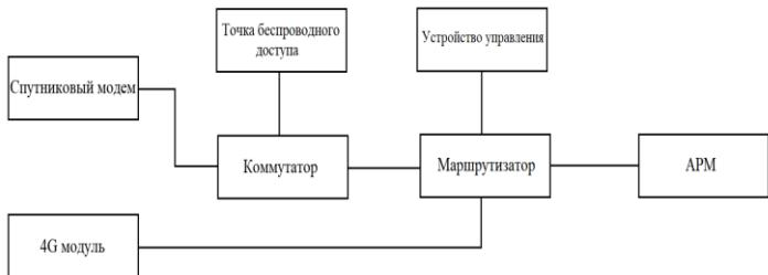
*Рис. 1. Структурная схема автоматизированной системы связи*
