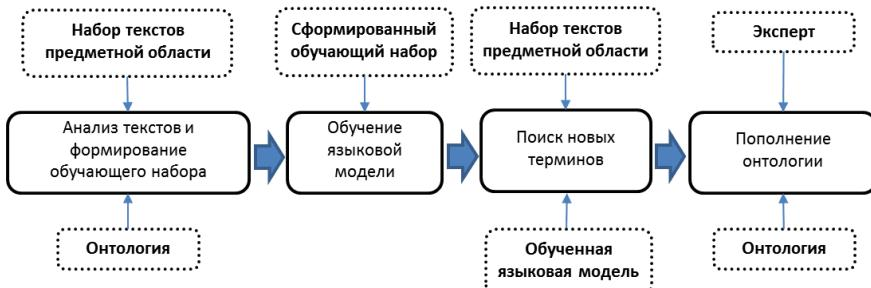
*Рис. 1. Схема применения технологии пополнения онтологии*
