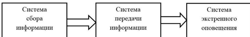
*Рис. 1. Структурная схема системы мониторинга выбросов вредных веществ*
