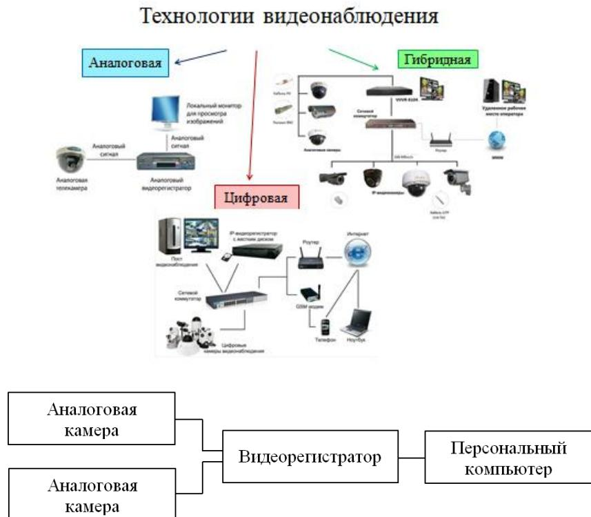
*Рис. 1. Структурная схема аналоговой системы видеонаблюдения*
