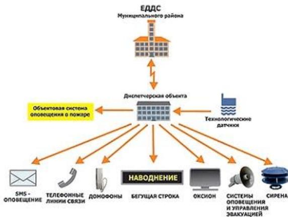
*Рис. 3. Структурная схема системы оповещения*
